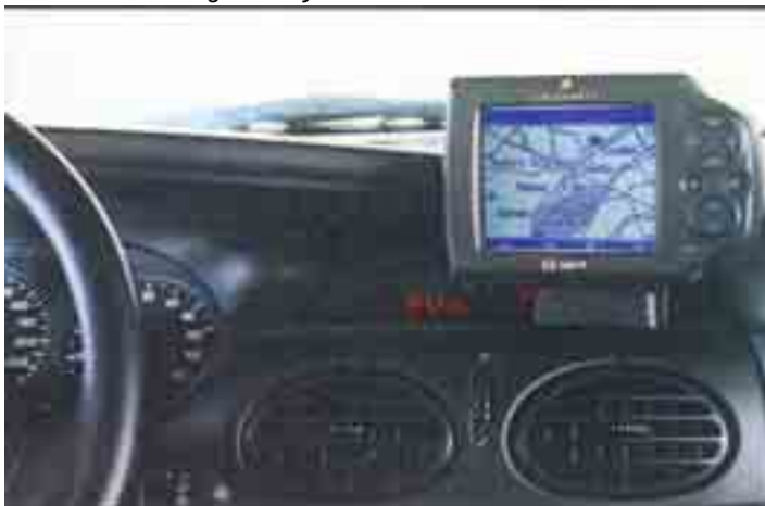
GPS-baseret navigationssystem installeret i bil
